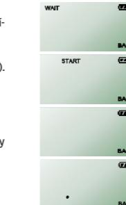
Stlačte tlačítko „START“. Na displeji sa krátko zobrazí počet vykonaných meraní. Detektor začne na displeji odpočítávať číslice až po 000. Behom tejto doby sa zahrieva senzor v detektore a celý prístroj sa pripravuje k činnosti. Tento proces trvá asi 20 sekúnd.
